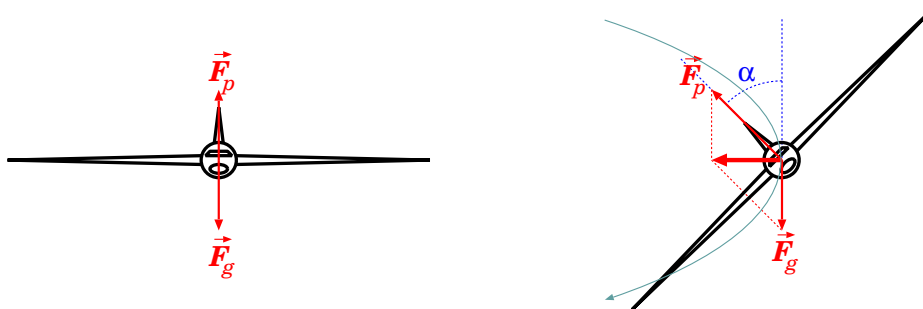
Figura 16.3: Esercizio dell'aereo in curva. A sinistra, la portanza \vec{F}_p bilancia esattamente la forza-peso \vec{F}_g . A destra, la risultante di portanza e forza-peso produce l'accelerazione centripeta necessaria a far curvare l'aereo: \vec{F}_g + \vec{F}_p = -m\frac{v^2}{\rho}\hat{\rho} .
